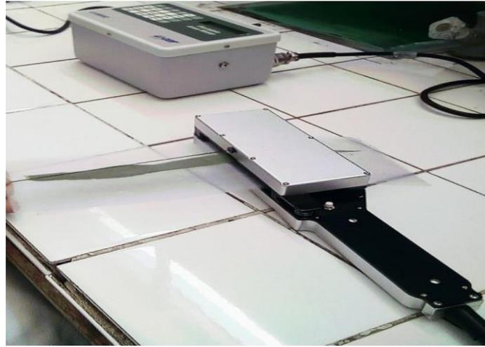
الشكل 08: جهاز Digital planimètre لقياس مساحة الورقة.
