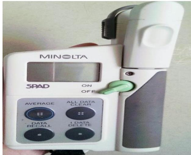
شكل 09: جهاز SPAD لتقدير الكلوروفيل الكلي في الورقة.
