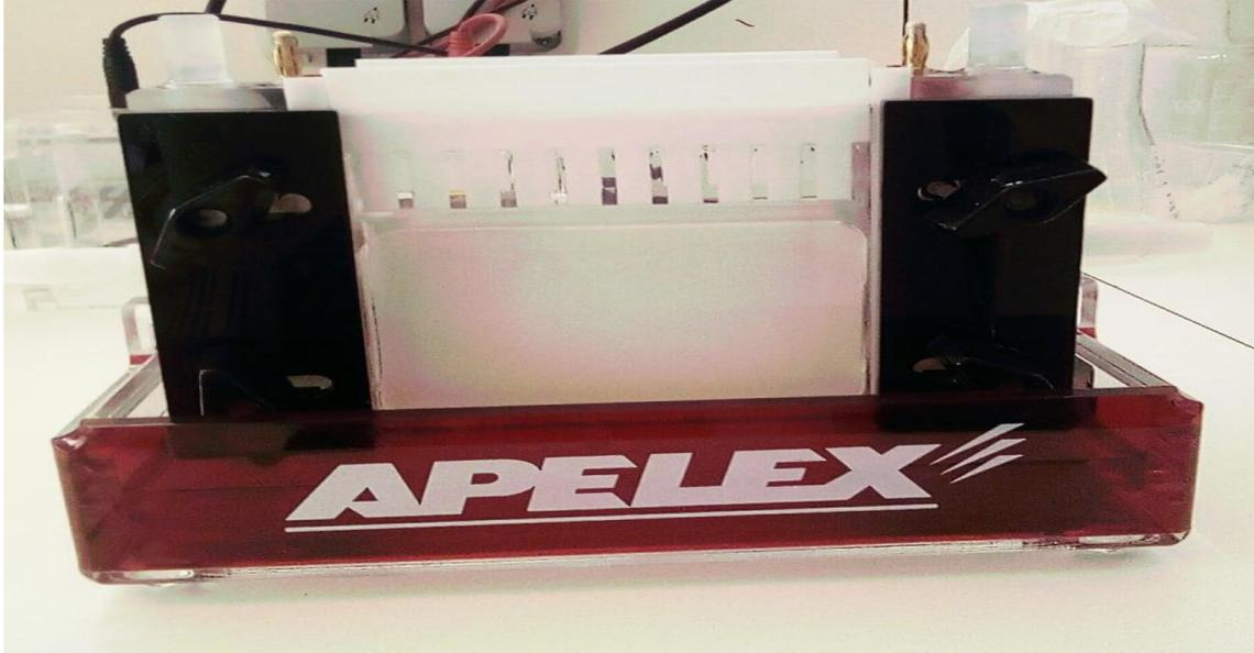
شكل 10: جهاز الرحلان الكهربائي.
